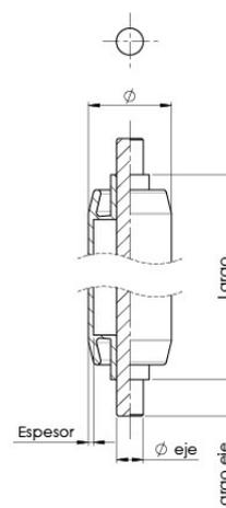
Tubo: Acero zincado - Eje con resorte. Rodamiento de semi-presión.
